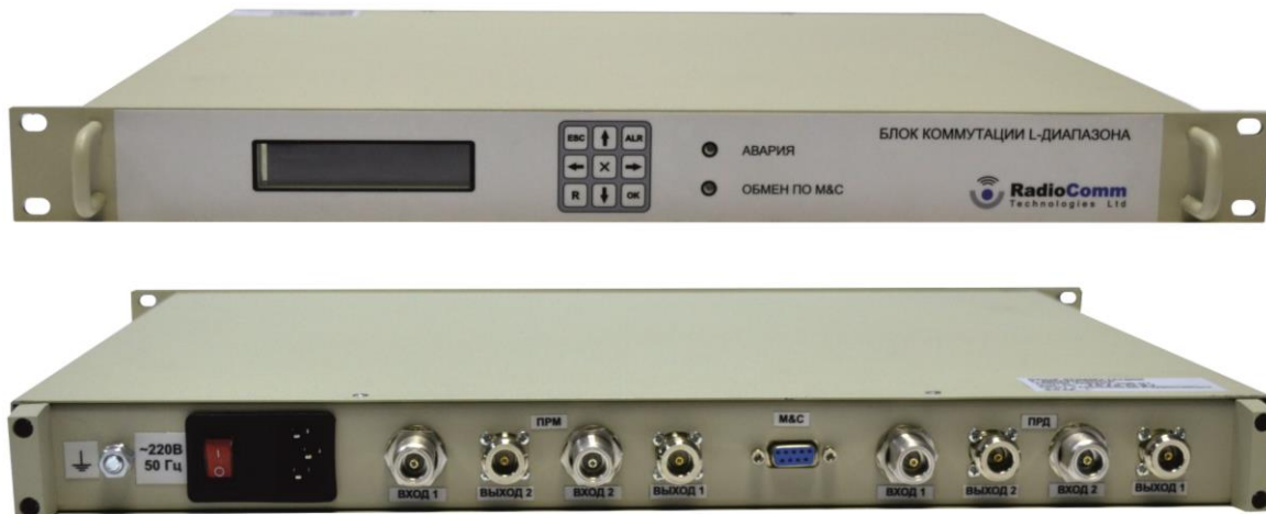
Рисунок 1.1 – Внешний вид передней и задней панелей Блока коммутации L-диапазона
